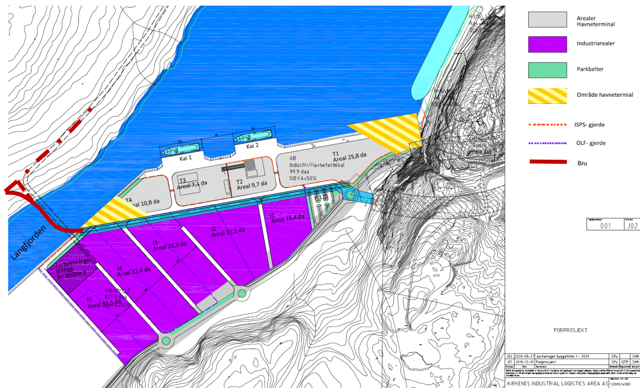
Figur 28-Planskisse - Kaiar, bru og veier over KILA, terminalområdet og industriområde, byggetrinn 1, med veiforbindelse til Strømmen bru og Kirkenes sentrum
