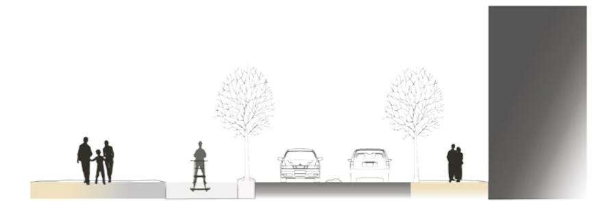
Fig 218: Snitt av gateløp i Sentrum med tydelig og trygg inndeling av biltrafikk, sykkel/spark og fotgjengere
