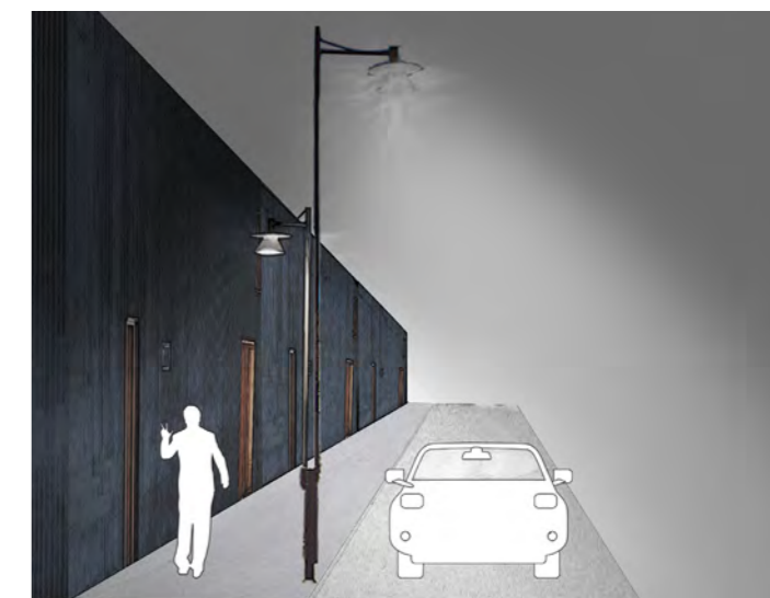
4. I gatene med biltrafikk (mellomblå og mørk blå strek på diagrammet) skal belysningen være i to høyder for å beholde den trygge og intime atmosfæren for gående. I bredere gater plasseres disse mastene på hver side.
