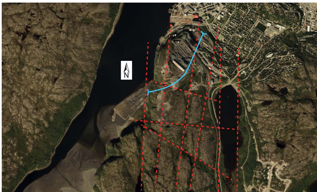
Figur 2: Ortofoto hvor synlige lineamenter er markert med stiplet rød linje. Blå linje viser omtrentlig planlagt trasé.
